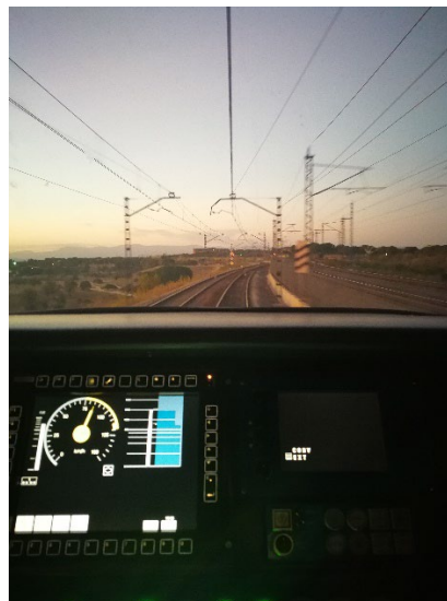
Figura 16. DMI (Drive Machine Interface). Fuente: elaboración propia fotografía tomada en Madrid, España (2017).
